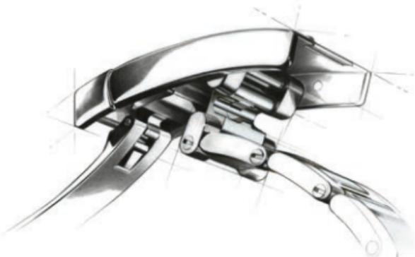
為了確保佩戴舒適，勞力士特別研製了易調鏈節延展系統。獨特的設計包含可向外拉伸或向內摺疊的鏈節，無需使用任何工具，便可延長或縮短錶帶約 5 毫米。
