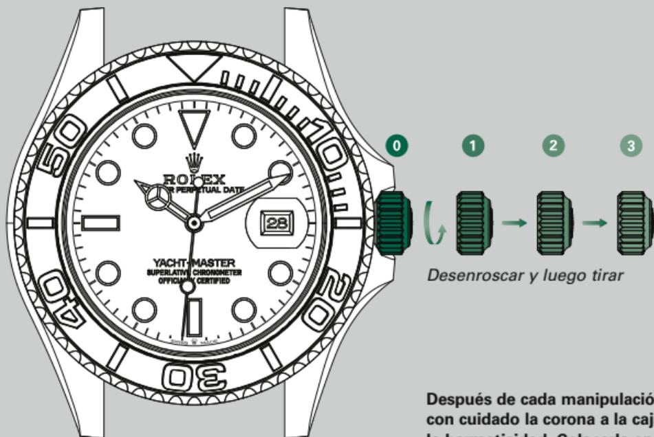
Después de cada manipulación, volver a enroscar con cuidado la corona a la caja para garantizar la hermeticidad. Colocarla en *posición 1*; a continuación, ejercer una ligera presión mientras se enrosca a la caja girándola en el sentido de las agujas. La corona en ningún caso debe manipularse bajo el agua.
