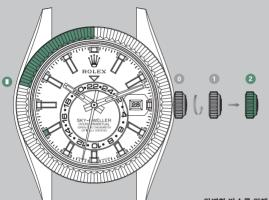
완벽한 방수를 위해서 각 기능 조작 후에는 크라운이 완전히 잠겨 있는지 항상 확인하시기 바랍니다. 크라운을 위치 1로 누른 후, 가볍게 누르면서 크라운이 완전히 잠길 때까지 시계 방향으로 돌려 잠급니다. 물속에서는 크라운을 조작하지 마시기 바랍니다.
