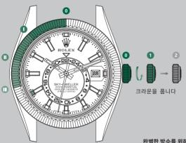
완벽한 방수를 위해서 각 기능 조작 후에는 크라운이 완전히 잠겨 있는지 항상 확인하시기 바랍니다. 크라운을 위치 1로 누른 후, 가볍게 누르면서 크라운이 완전히 잠길 때까지 시계 방향으로 돌려 잠급니다. 물 속에서는 크라운을 조작하지 마시기 바랍니다.
