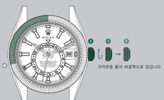
완벽한 방수를 위해서 각 기능 조작 후에는 크라운이 완전히 잠겨 있는지 항상 확인하시기 바랍니다. 크라운을 위치 1로 누른 후, 가볍게 누르면서 크라운이 완전히 잠길 때까지 시계 방향으로 돌려 잠급니다. 물 속에서는 크라운을 조작하지 마시기 바랍니다.
