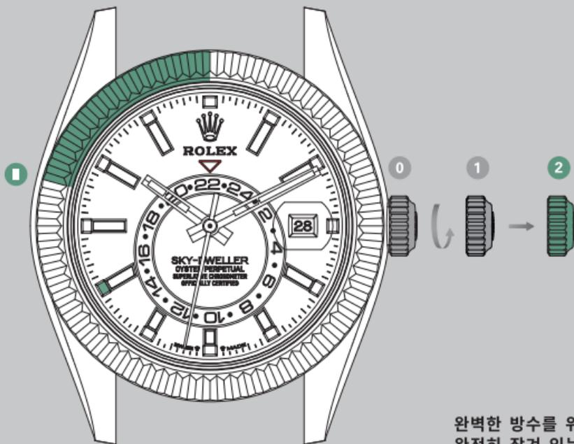
완벽한 방수를 위해서 각 기능 조작 후에는 크라운이 완전히 잠겨 있는지 항상 확인하시기 바랍니다. 크라운을 위치 1로 누른 후, 크라운을 가볍게 누르면서 완전히 잠길 때까지 시계 방향으로 돌려 잠급니다. 물 속에서는 크라운을 조작하지 마시기 바랍니다.
