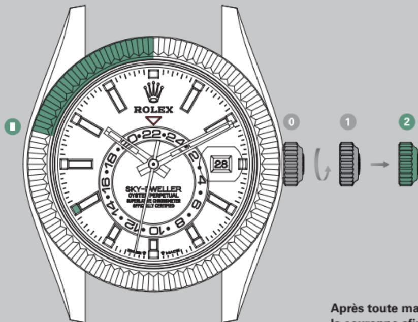
Après toute manipulation, revisser soigneusement la couronne afin de garantir l'étanchéité. Ramener la couronne en *position 1*, puis appliquer une légère pression tout en la vissant dans le sens horaire contre le boîtier. La couronne ne doit en aucun cas être manipulée sous l'eau.
