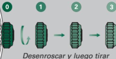
Después de cada manipulación, volver a enroscar con cuidado la corona a la caja para garantizar la hermeticidad. Colocarla en *posición 1*; a continuación, ejercer una ligera presión mientras se enrosca a la caja girándola en el sentido de las agujas. La corona en ningún caso debe manipularse bajo el agua.
