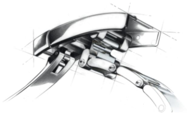
Con el fin de garantizar una comodidad óptima para el usuario, Rolex ha creado el cómodo sistema de extensión rápida Easylink. Disponible en determinadas modalidades, este sistema exclusivo, que consiste en un eslabón que se puede desplegar o replegar sobre sí mismo, permite ajustar la longitud del brazalete en aproximadamente 5 mm, sin necesidad de herramienta alguna.
