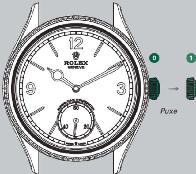
Após cada operação, coloque a coroa de volta na *posição 0*. A coroa nunca deve ser manipulada quando o relógio estiver na água.
