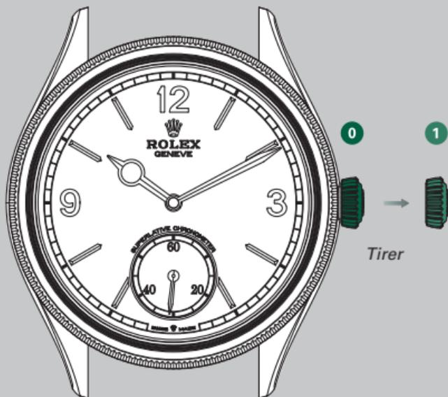
Après toute manipulation, ramener la couronne en *position 0*. La couronne ne doit en aucun cas être manipulée sous l'eau.
